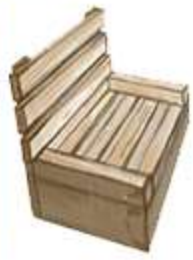
2 SIEDZISKO MATERIAŁ: palety WYKONANIE: poprzez oszlifowanie desek, pomalowanie białą bejcą, montaż według zaprojektowanego kształtu
