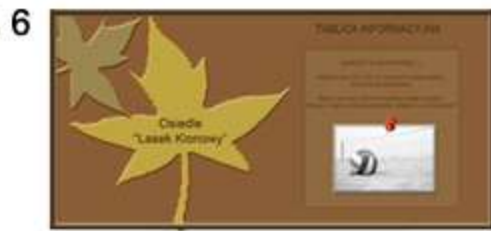
6 OSIEDLWA TABLICA INFORMACYJNA MATERIAŁ: drewno, szyba, metalowy słupek WYKONANIE: obróbka drewnianych desek, montaż szyby, umieszczenie aktualnych informacji, zamocowanie tablicy na słupku oraz zakotwienie w gruncie.
